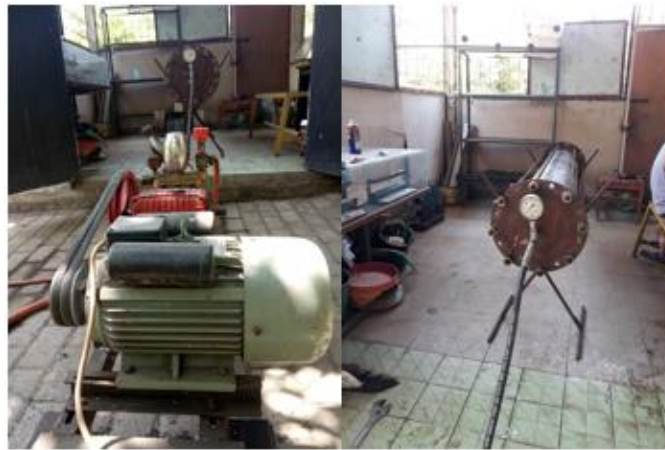
Gambar 1.1 Pengujian Tekanan Hidrostatik
