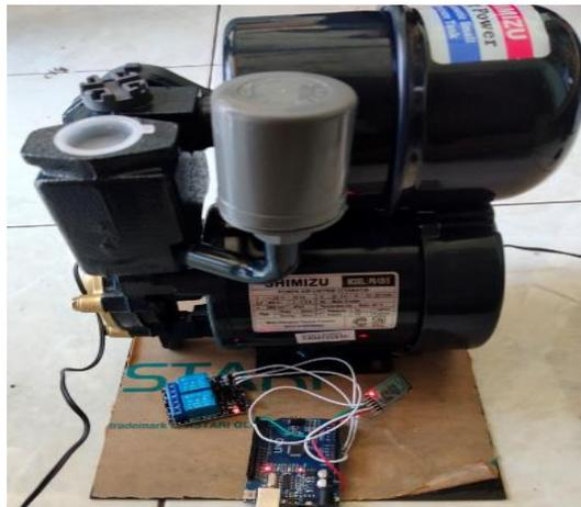
Mesin Air Rotor Aplikasi android    Mesin sirkulasi Air berbasis sensor mikrokontroler
